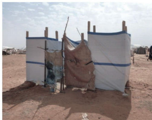
Εικόνα 49: Ντούζ έκτακτης ανάγκης όπου οι χρήστες εγκατέστησαν το δικό τους όριο
